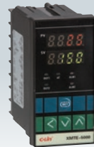
XMTE-5000 系列 智能温度控制仪 多种传感器输入用户任意设定
